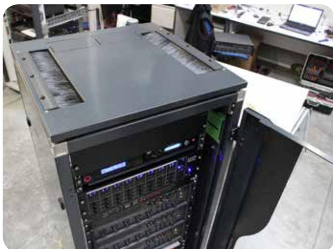
À la demande, le matériel peut être monté en baie ou en coffret, testé et programmé dans nos ateliers pour être livré 'prêt à l'emploi' sur le lieu de l'installation.
