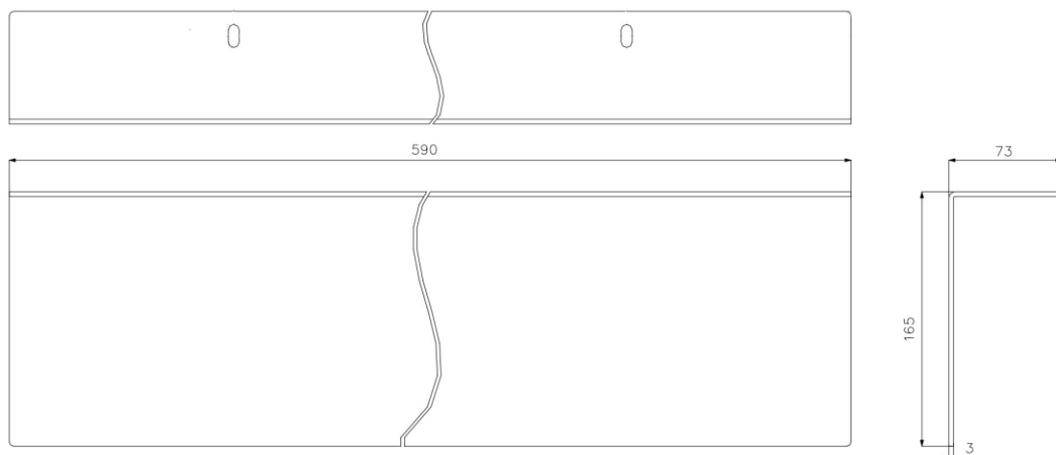
*Socle antibasculement pour baie largeur 800mm*
