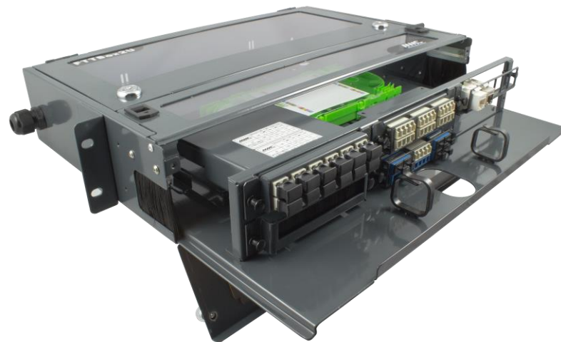
Plateau coulissant et ½ porte avant : Accès aux 6 Modules LGX et à la cassette d'épissurage
